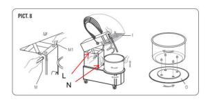
BEFORE OPERATING THE MACHINE, THE PROTECTION I CPICT. 9) MUST BE COMPLETELY LOWERED. FOR TILTING HEAD MIXERS IT MUST BE CHECKED THAT THE BOWL IS CORRECTLY INSERTED AND BLOCKED BY THE DISK O AND THAT THE TOP IS DOWN AND BLOCKED BY THE CHECK PIN M CTHIS MUST BE COMPLETELY INSERTED).
